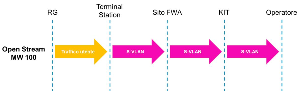
**Figura 22 – Distribuzione VLAN per OpenStream MW100**
