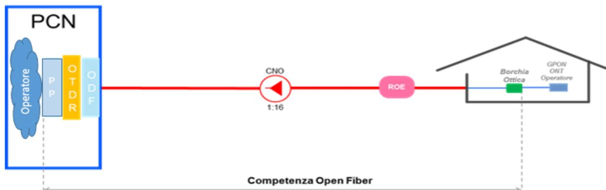
**Figura 23 – Configurazione per la Colocazione al PCN**
