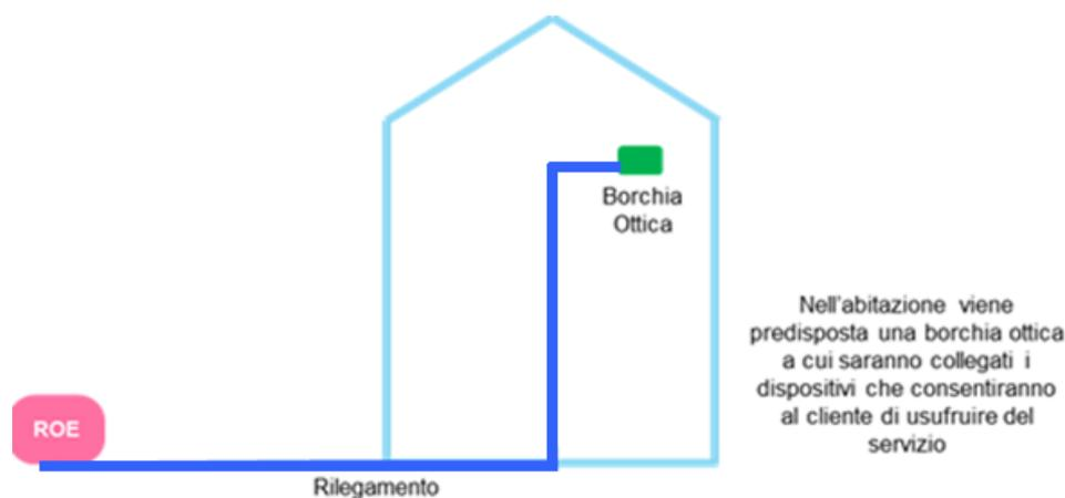
**Figura 4 – Descrizione del Cablaggio della singola UI**
