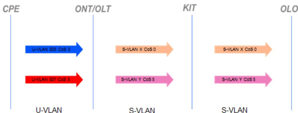
**Figura 12 – Modello VLAN Mono CoS Single Tag N:1**
