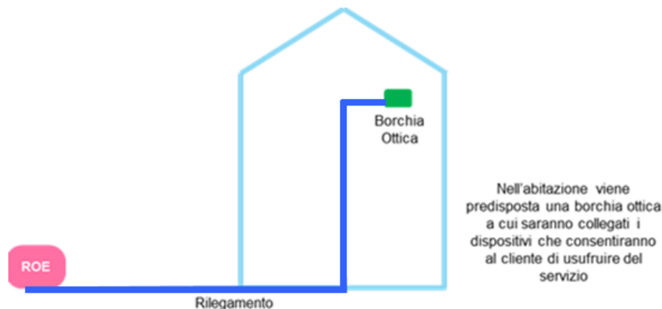
Figura 4 – Descrizione del Cablaggio della singola UI
