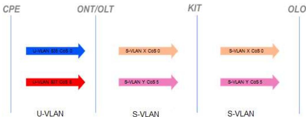
**Figura 10 - Modello VLAN Mono-CoS single-tag N:1**
